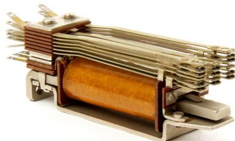
Bild 32 Flachrelais Typ Siemens Albis SAZ. Dieser Relais Typ wurde ab 1949 bis in die 1980er Jahre eingesetzt. Objekt 9439.640-005-2
