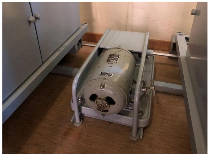
Bild 47 Der zentrale Elektromotor als typisches Merkmal des Systems Rotary. Über Antriebswellen, Winkelgetriebe und Kupplungen wird die Drehbewegung auf die einzelnen Schaltgruppen übertragen. (Museum für Kommunikation)
