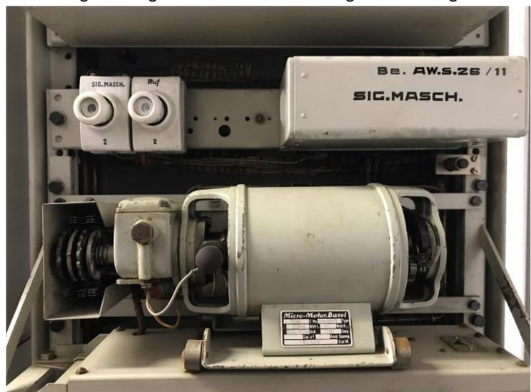
Bild 20 Signalmaschine in der Zentrale Frieswil. Der Elektromotor treibt die links angeflanschten Nockenscheiben an. Je nach Oberfläche dieser Scheiben wird – vergleichbar mit einer Musikkdose - ein kontinuierlicher oder aber ein unterbrochener Summton erzeugt. (Museum für Kommunikation)
