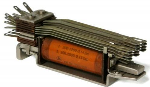
Bild 18 Flachrelais von Siemens-Albis mit drei senkrechten Kontaktfedern. Relais dieses Typs wurden tausendfach in Telefonzentralen eingesetzt. (Museum für Kommunikation, 9439.640-005-1)
