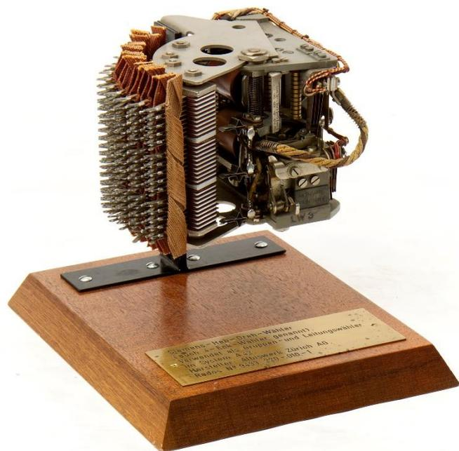
Bild 34 Leitungswähler Albis, 100er-Hebdrehwähler Mod. 1927, hier die kleine Ausführung, Amtszentrale SAZ Mod. A42. 10 Positionen der Hebebewegungen, die den 10 Wahlstufen entsprechen. 10 Positionen der Drehbewegungen, die beim Gruppenwähler zum Suchen einer freien Leitung und beim Leitungswähler zum Auszählen der Rufnummer dienen. (Museum für Kommunikation, 9433.220-010-1)
