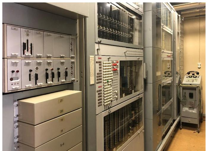
Bild 48 Einheitsgestell mit Register für die Zwischenspeicherung der gewählten Rufnummer. (Museum für Kommunikation)
